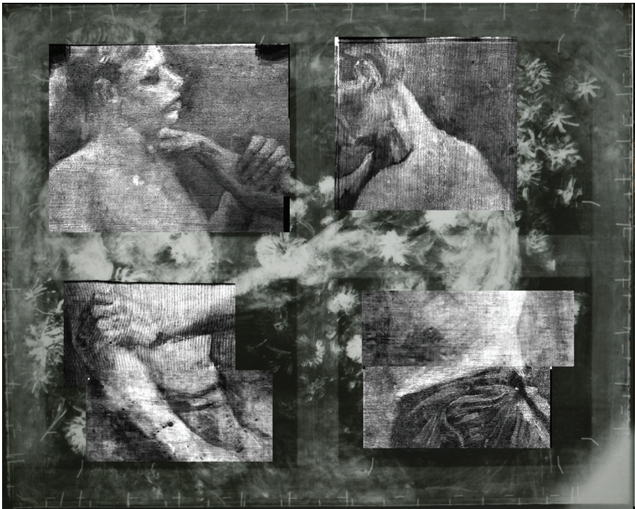
Vier opnames laten de verdeling zien van zinkwit, vastgelegd door MA-XRF vanaf de achterzijde bij DESY (Hamburg) en de grovere afbeeldingen van het Kröller-Müller Museum, waaroverheen de röntgenopname is gelegd.
