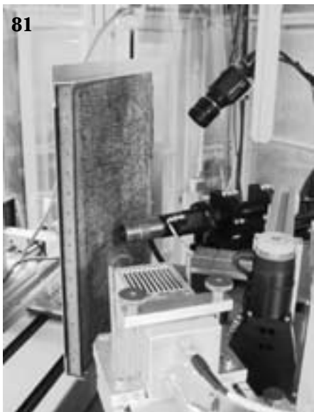
81 Grasgrond wordt gekanteld gescand met XRF
